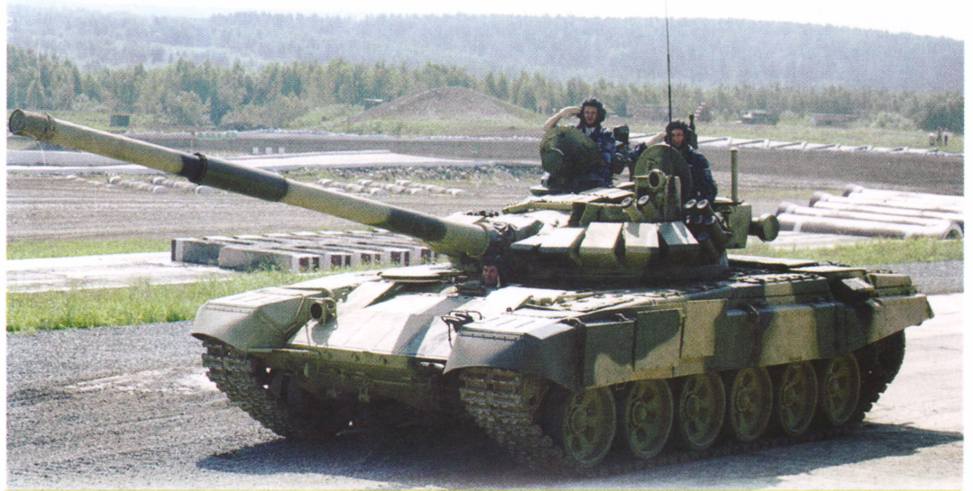
Танк Т-72М1. На борту машины хорошо видны противоккумулятивные экраны.
